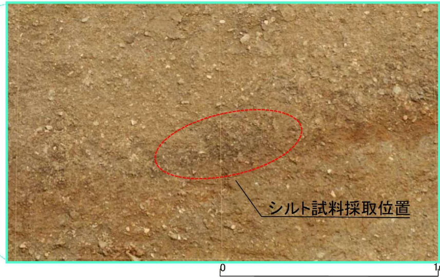
シルト試料例(崖錐堆積物2層より採取)
