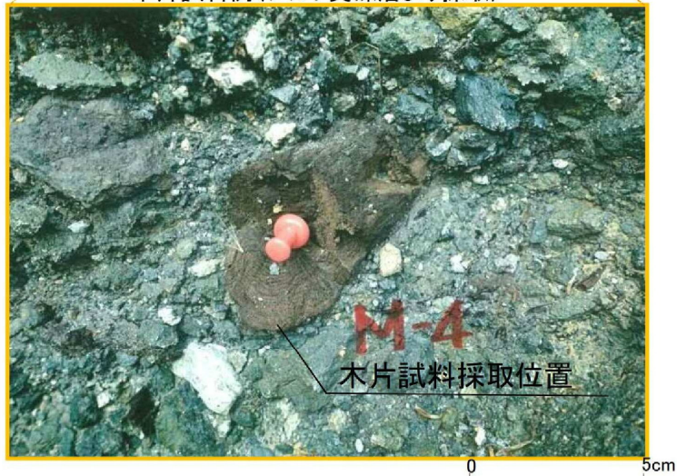
木片試料例(シルト質礫層より採取)
